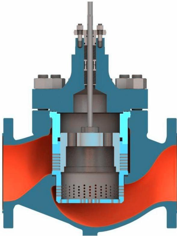
◆低噪音笼式调节阀可以降低可压缩流体的噪音，为适应气体节流扩散与膨胀，套筒上设有许多对称小孔来降低压力降；阀芯采用压力平衡式结构。阀体结构紧凑，流体通道呈S型，还有一个改善套筒周围流体平衡流动的导流翼，使其压降损失小，流量大，噪音低。调节阀泄漏量符合ANSI B16.104标准。调节阀配用气动薄膜执行机构、气动活塞式执行机构或电动执行机构，其结构紧凑，输出力大。
